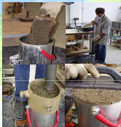
Processo de elaboração das misturas de CCR
