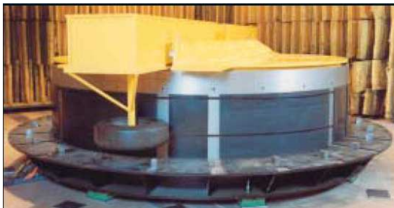
Figura 8: Tyre/Pavement Test Aparatus (TPTA) Fonte: Garcia et al. (2002)
