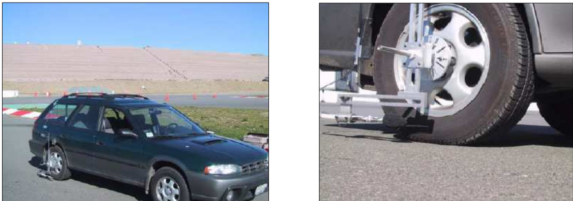
Figura 4: Equipamento de ensaio do método CPI Fonte: Hanson et al. (2005)
