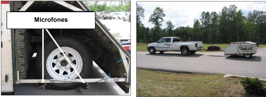
Figura 3: Equipamento de ensaio do método CPX Fonte: Hanson et al. (2005)
