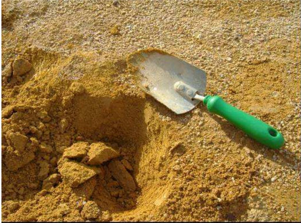
Figura 178 - Residual de granito, horizonte B. Amostra 43. Km 268. Altitude 196 m. DSCF0426
