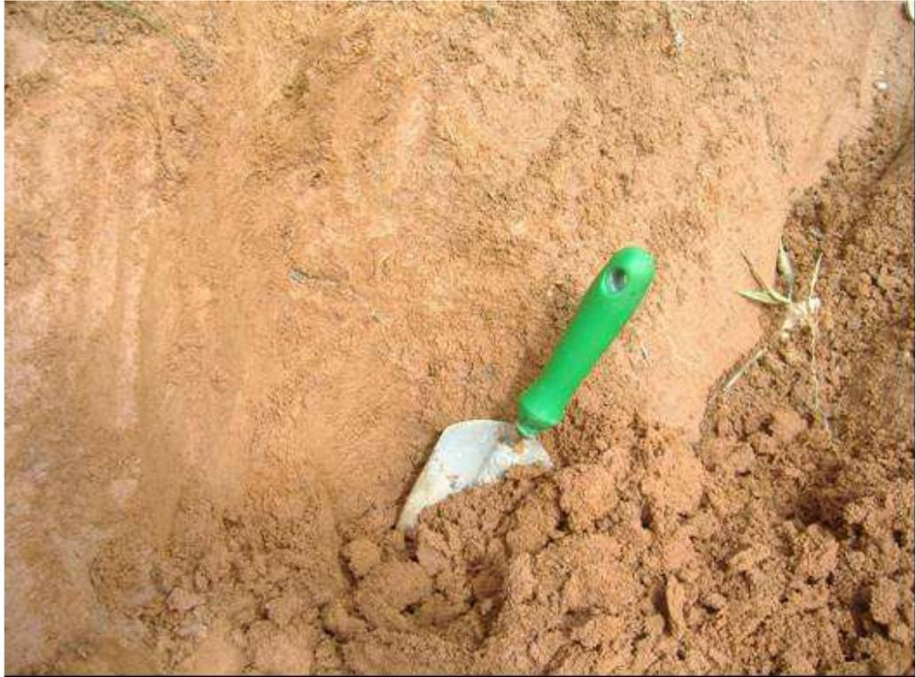
Figura 134 - DSCF0406 Solo residual, transição do horizonte B para o C, nível do greide da rodovia. Amostra 31. Km 66. Altitude 230 m.
