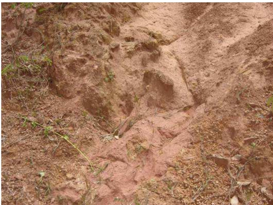
Figura 153 - Solo Siltoso. Região com blocos de granito nas encostas. Horizonte C.
