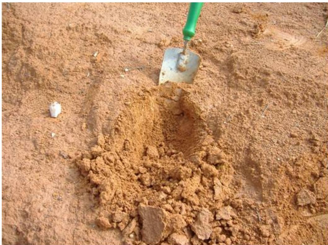
Figura 132 - DSCF0404 Solo residual de granito laterítico. Amostra 30. Km 56. Altitude 230 m.
