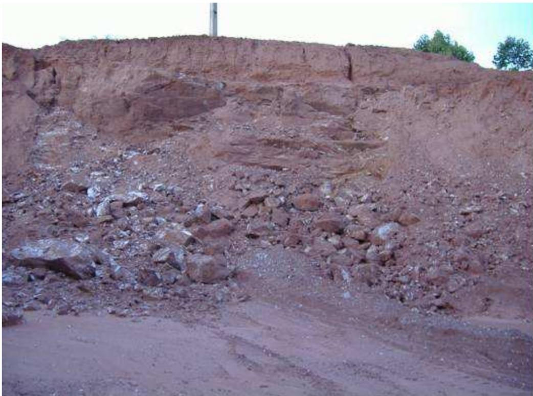
Figura 114 - Jazida de revestimento primário de riólito (ígneia sílica). Km 273, cerca de 25 km antes de Nova Progresso. Altitude 236m. DSCF0389
