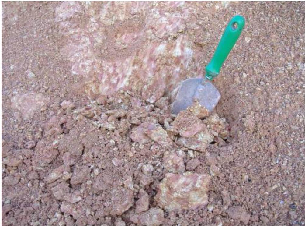
Figura 111 - Solo residual horizonte C de rocha sedimentar. Presença de minerais expansivos. DSCF0386 Amostra 25. Km 268.
