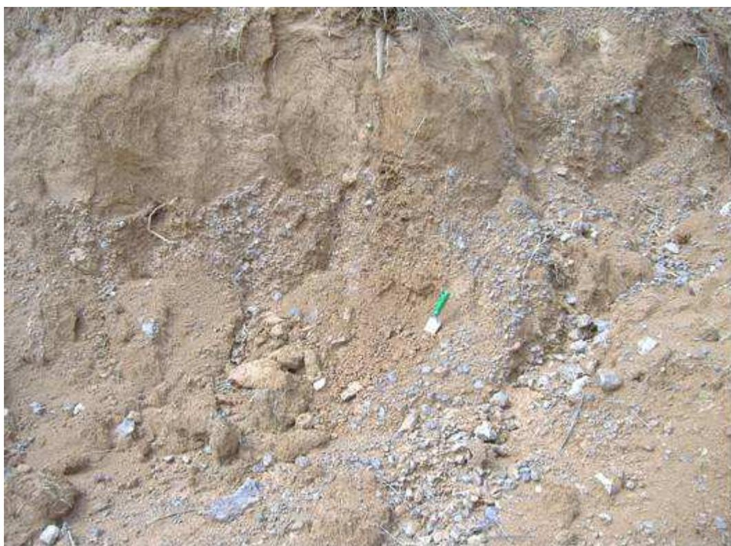
Figura 137 - DSCF0411 Solo residual de granito. Horizonte C. Amostra 32. Km 86.
