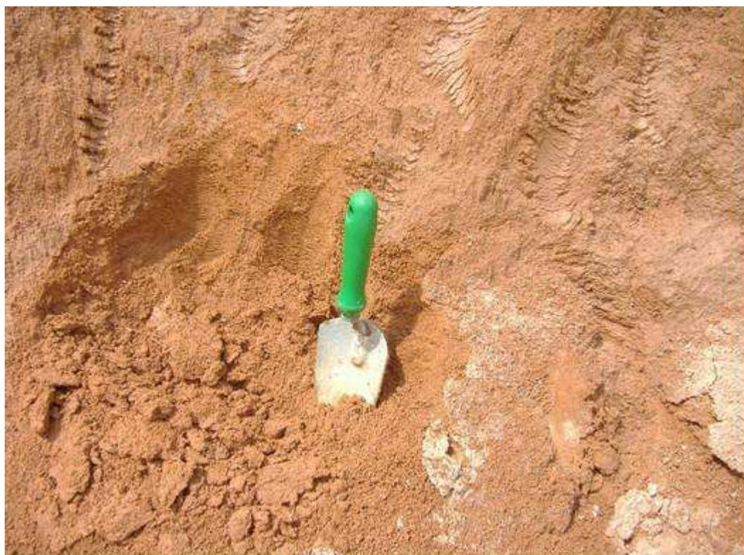
Figura 173 - Solo residual de granito laterítico. DSCF0423213 Amostra 41. Km 213. Altitude 117 m.
