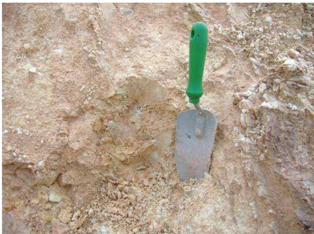
Figura 121 - DSCF0395 Solo residual de siltito horizonte C. Presença de minerais expansivos. Amostra 27. Km 15,2. (Zero no trevo principal de Novo Progresso. Km 15,2. Altitude 211m.
