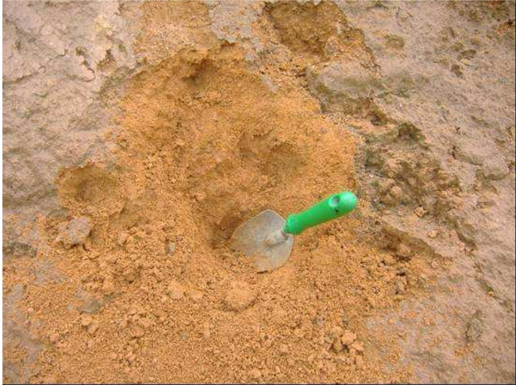
Figura 22 - Solo argiloso laterítico. Amostra coletada a 5 km do distrito de Terra Nova.
