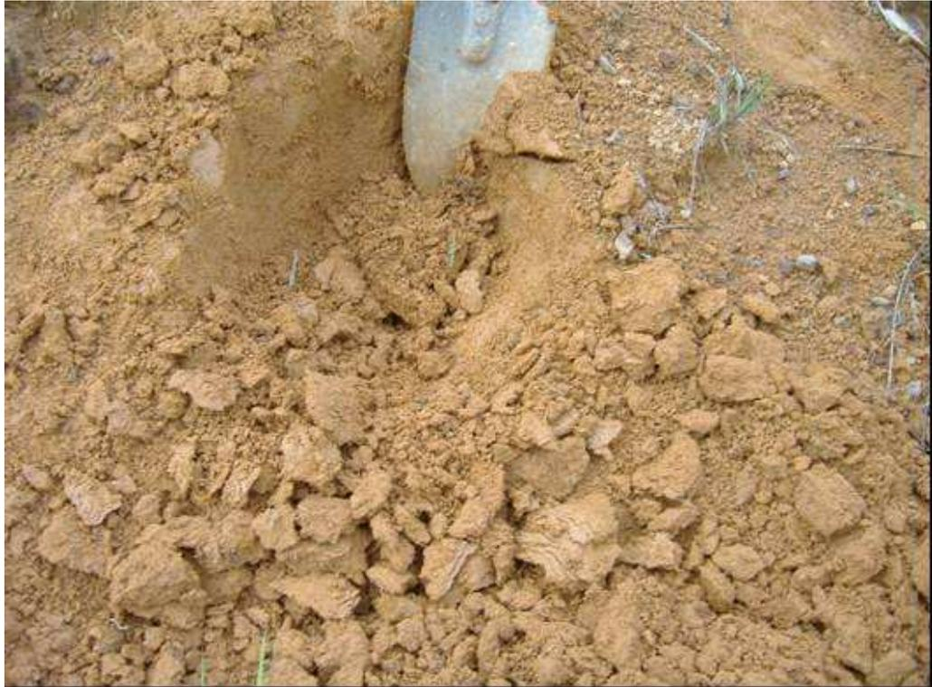
Figura 184 - Residual de granito. Horizonte B. Amostra 44. Km 290. Altitude 149 m.
